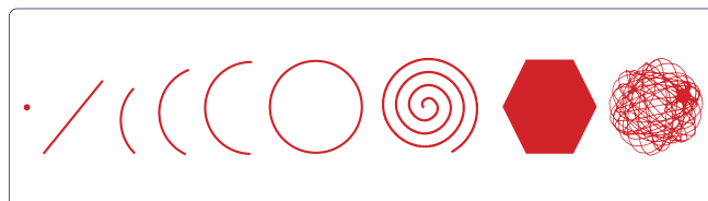
Рисунок 4. HiScan Surgical может генерировать наиболее подходящие формы сканирования для микрохирургии, в том числе: точки, линии, кривые и полные окружности, спирали, шестиугольники (прогрессивное и связанное сканирование), двойные интерполяционные эллипсы.
