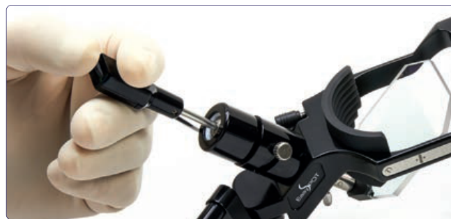
Рисунок 5. Благодаря пульту дистанционного управления, расположенному на джойстике, все основные функции находятся под непосредственным контролем хирурга, который может выполнять операцию, не отрывая глаз от микроскопа.
